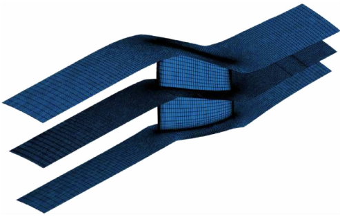
图 2 Rotor 36 单流道网格
